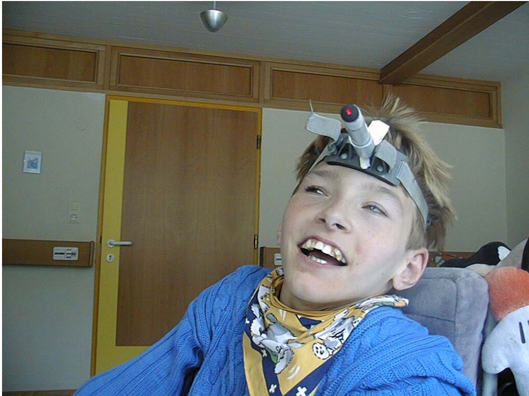
Das Stirnband mit Laser und IR Sender
