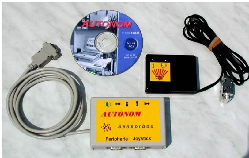
**Bild 1:** Die Grundkomponenten von AUTONOM: CD-ROM mit AUTONOM Software und Sprachsynthese, Sensorbox zum Anschließen der Eingabesensoren (unten) und Infrarot-Sender zur Umgebungssteuerung (rechts).
