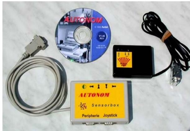
Einige Komponenten von **AUTONOM**: CD-ROM mit Software (oben), Sensorbox zum Anschluß der Eingabeschalter (unten), lernfähiger Infrarot-Sender zur Umgebungssteuerung.
