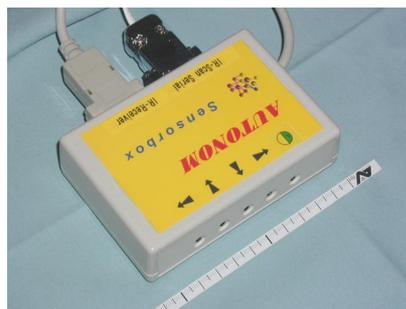
**AUTONOM Sensorbox** (angeschlossen am seriellen Ausgang des Laptop); Ist Verbindungsstelle zwischen PC und Eingabekomponenten. Die Verbindung zu diesen Komponenten ist sowohl direkt mit Kabel als auch über Infrarot - via IR-Receiver - möglich.
