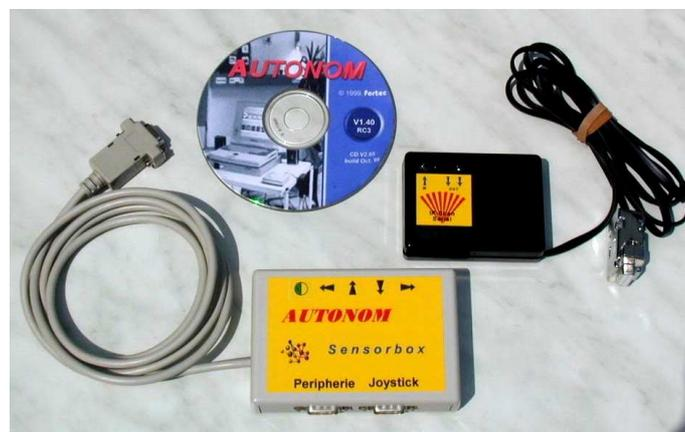
Abb. 11: Die Komponenten der kommerziellen Version von AUTONOM: CD-ROM mit Software, Sensorbox zum Anschluß der Spezial-Eingabesensoren und ein lernfähiger Infrarot-Sender zur Umgebungssteuerung.
