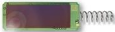
Enocean Funkmodul mit Versorgung durch Solarzelle
