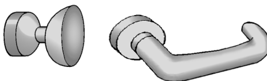
Abb. B 2.23: Kraftschluß (links) und Formschluß (rechts); nach [WOC 94].
