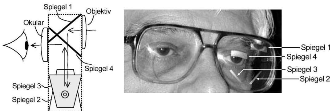
Abb. C 1.5: Teleskop, in ein Brillenglas integriert links: Strahlengang (nach [PEL 02]); rechts: Simulation des Aussehens [PEL 02].
