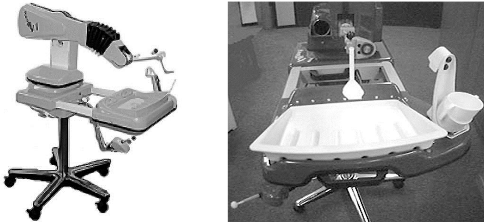
Abb. C 3.6: Roboter Handy 1: links: Gesamtansicht; rechts: Ansicht von vorne, Tablett für Speisen, darüber der Löffel am Roboterarm und rechts ein Becher [TOP 97, TOP 98].
