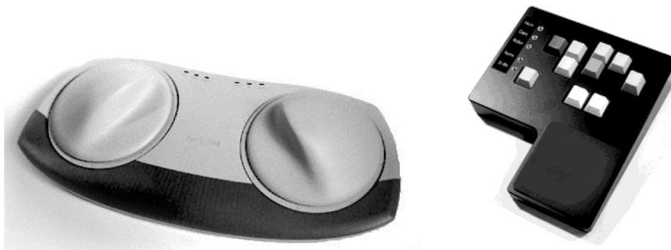
Abb. B 2.5: Beispiel für speziell geformte Tastaturen: links: Keybowl; rechts Einhandtastatur (Octima).
