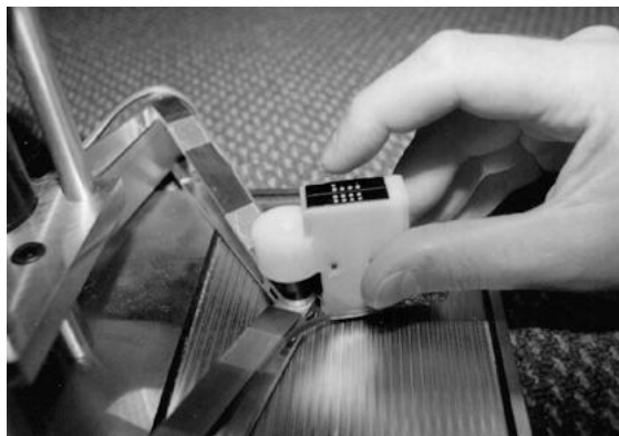
Abb. B 2.53: Pantobrilie – Die beiden Braille-Displays sind auf den Armen eines Pantographen montiert [RAM 96].
