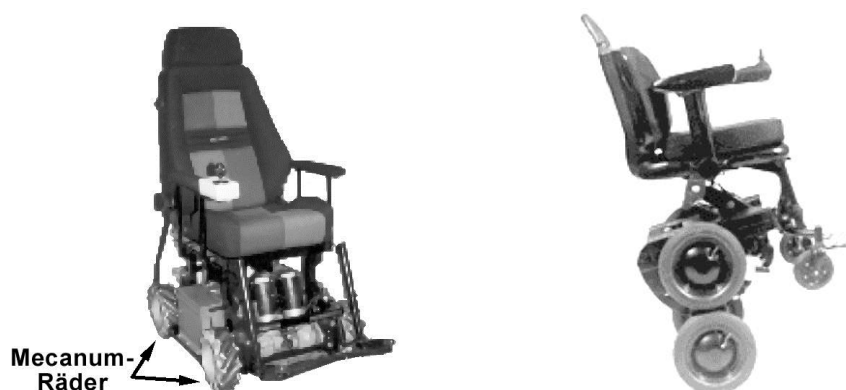
Abb. C 2.6: links: Omnidirektionaler Rollstuhl "OMNI" (FernUni Hagen); rechts: Balancierender Rollstuhl IBOT 3000 TRANSPORTER (Johnson & Johnson).
