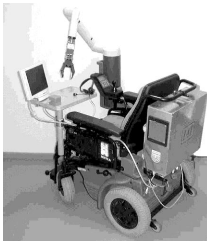
Abb. C 3.8: MANUS-Arm auf einem Rollstuhl montiert [BOR 99a].
