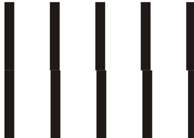
Abb. A 2.11: "Nonius-Auflösung" – Das Auge nimmt Verschiebungen zwischen zwei Linien bereits ab einem Winkel von 2 Bogensekunden wahr.
