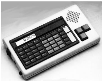
Abb. C 4.1: Tischrechner für blinde Menschen: links: Tischrechner mit Sprachausgabe; rechts: Tischrechner mit Braille-Display.
