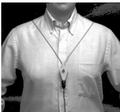
Abb. 7.35: links: um den Hals getragene Induktionsschleife (neck loop) rechts: Ohrhaken (silhouette inductor)
