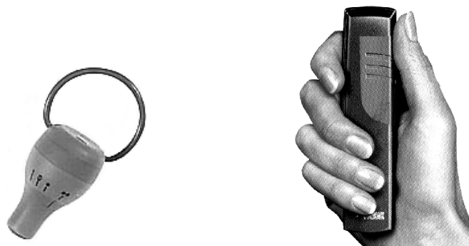
Abb. 7.39: links: FM-Empfänger in ITC Bauform rechts: Funk-Mikrofon mit einstellbarer Richtcharakteristik – Zoom-Mikrofon (Phonak)
