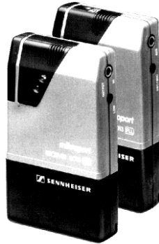
Abb. 7.37: FM Übertragungsanlage – Sender und Empfänger (Mikroport von Sennheiser)
