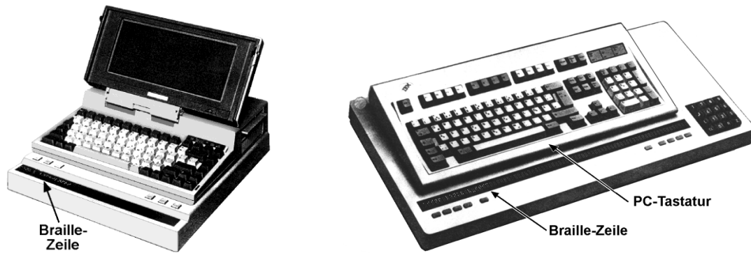
Abb. 9.32: links: Notebook-PC mit Braille-Zeile (Human Ware); rechts: Braille-Zeile für einen PC
