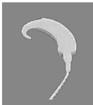
Abb. 7.35: links: um den Hals getragene Induktionsschleife (neck loop) rechts: Ohrhaken (silhouette inductor)
