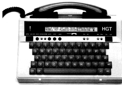
Abb. 8.9: Texttelefon mit Akustikkoppler (stationär und mobil)
