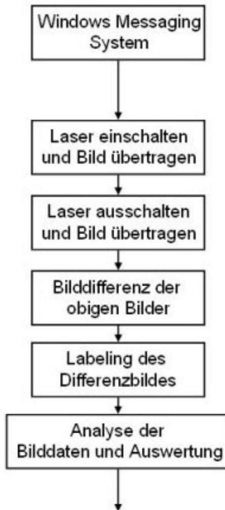
Abbildung 6.11: Flussdiagramm des Hostsystems
