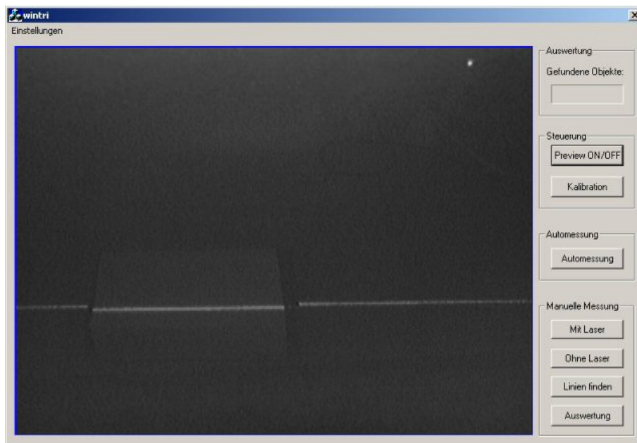
Abbildung 7.8: Voransicht der ersten Messung (Abstand Lasermodul und Kamera: 40mm)
