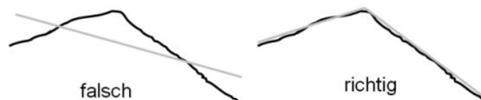
Abbildung 7.6: Mögliche Szenarien bei der Bildung der Regressionsgeraden
