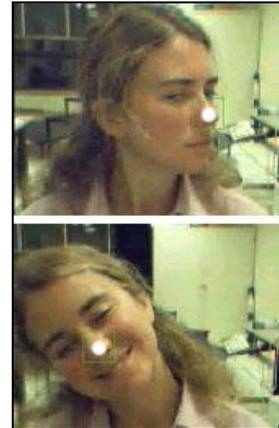
Abb. 2.36: Tracking der Nase für die Cursorsteuerung
