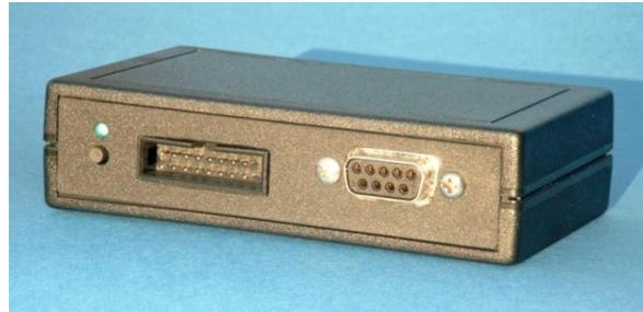
Abb. 3.20: Der *MonolithEEG*-Verstärker
