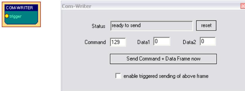
Abb. 7.37: Parameterdialog des *Com-Writer*-Elementes
