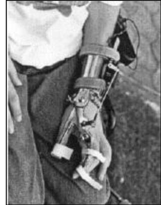
Abb. 2.41: BCI-gesteuerte Orthese
