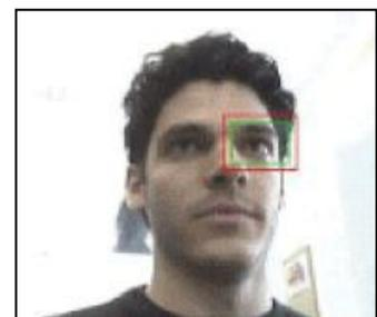
Abb. 2.35: Augendetektion in Echtzeit mit einer Webcam
